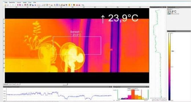
**La función de fusión o "Merging" reúne varios ángulos visuales de la cámara en una sola imagen**
