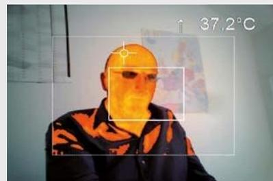
*Fusión de imagen VIS por encima de la temperatura de 35 °C*
