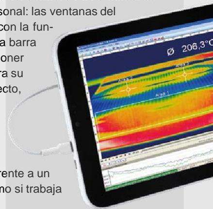
El software PIX Connect ofrece una amplia selección de gamas de colores predeterminadas. Así se pueden reproducir de modo óptimo los contrastes térmicos. Las gamas de colores predeterminadas se pueden personalizar con el fin de satisfacer los requisitos específicos de cada uno.
