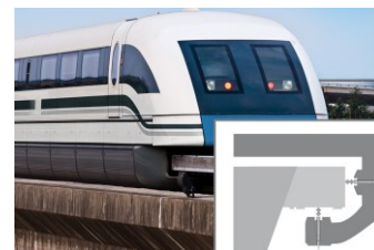
Control de distancia en rails magnéticos
